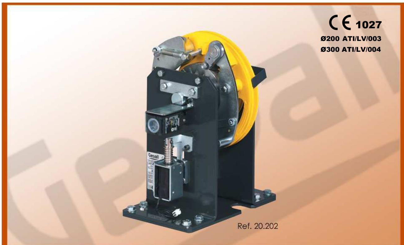
■ Ces limiteurs agissent quand les leviers s'ouvrent sous l'effet de la force centrifuge, lorsque, la cabine est en survitesse aussi en montée qu'en descente.
